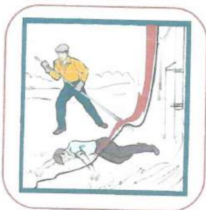
Рис.6. Освобождение пострадавшего от токоведущей части, находящейся под напряжением до 1000 В
