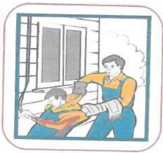
Рис.7 Освобождение пострадавшего от токоведущей части, находящейся под напряжением до 1000 В
